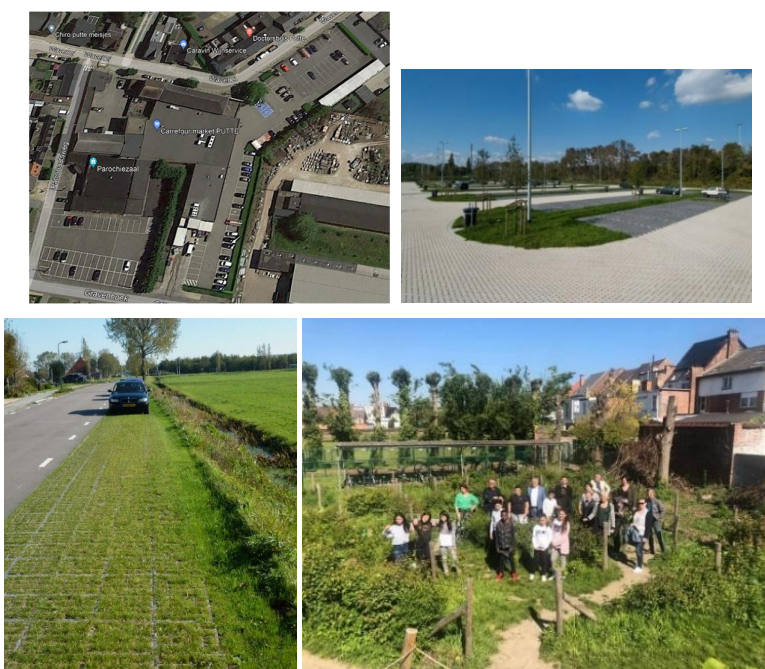
Figuur 7-2 : Voorbeelden van het toepassen van ontharden op de parking van de Carrefour te Putte (linksboven; bron: google maps) en een carpoolparking te Hasselt (rechtsboven ; bron: foto Ebema) en de ontharde speelplaats van basisschool De Knipoog te Vilvoorde (rechtsonder; bron: Provincie Vlaams-Brabant, 2019))
